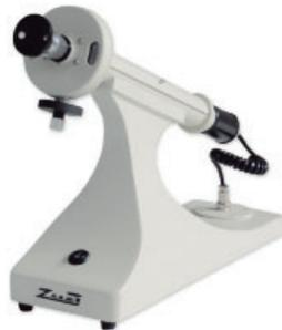
1 | Compartiment d'échantillon incliné pouvant accueillir des tubes jusqu'à 220 mm.
